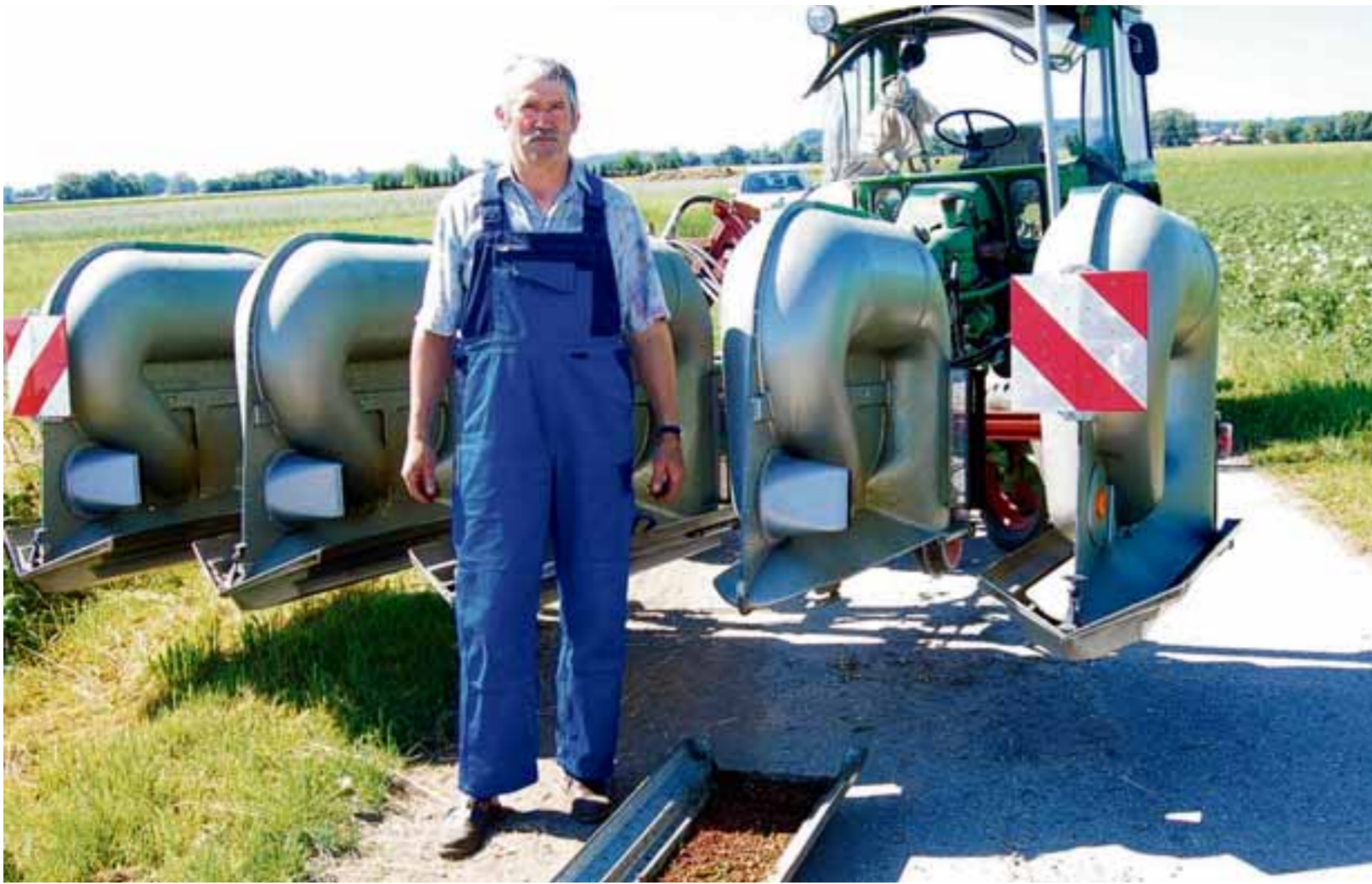
Biobauer Fritz Bichler aus Salgen mit seinem Kartoffelkäfer-Absammelgerät, das bei einer Fahrt fünf Kartoffelstrangen erfasst.
